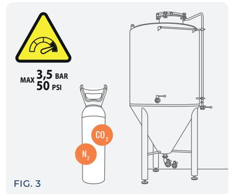
Controlar que las presiones de la instalación para el llenado sean correctamente configuradas e inferiores al valor máximo indicado (3.5 bar/50 psi).
